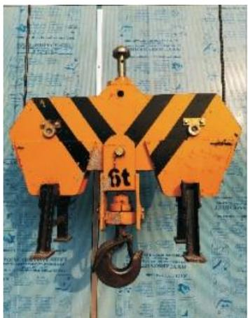
吊钩防脱钩、冲顶防坠落装置
