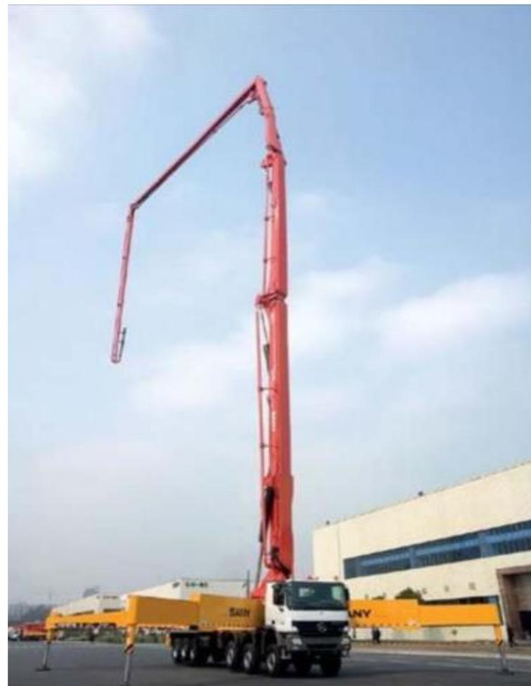
混凝土汽车输送泵
